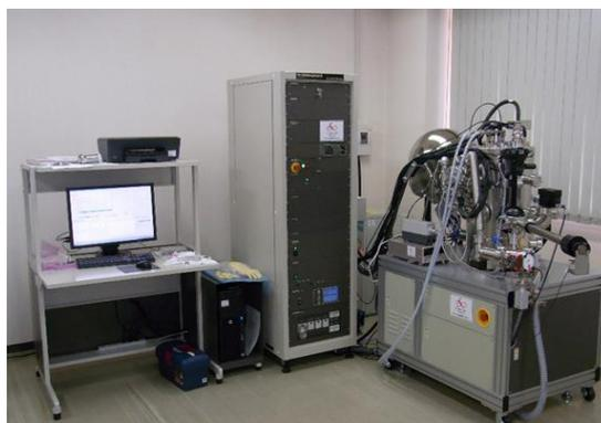
X線光電子分光分析装置の概観
