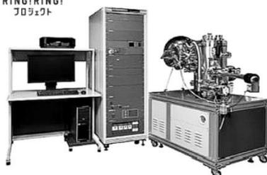
材料表面を構成する元素組成や化学状態を、数nm以下の深さで分析します。試料の表面にX線を照射し、光電効果により発生する光電子の運動エネルギーを計測することで原子の結合エネルギーを求めることができます。この結合エネルギーは各元素に固有で、さらに周囲の元素との結合状態によりわずかに変化するため、試料最表面の成分分析・状態分析が可能となり、さらにイメージング測定も可能です。また、Arイオン銃によるエッチングを併用することで試料表面から深さ方向への分析（デプスプロファイル測定）や、トランスファーベッセルを利用することで空気や水分に敏感な試料を外気に晒すことなく測定（大気非露露測定）することが可能です。
